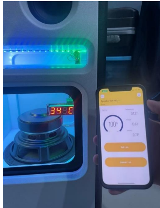
รูปที่ 7 แสดงการตรวจวัดอุณหภูมิลำโพงไอโอทีไร้สาย
