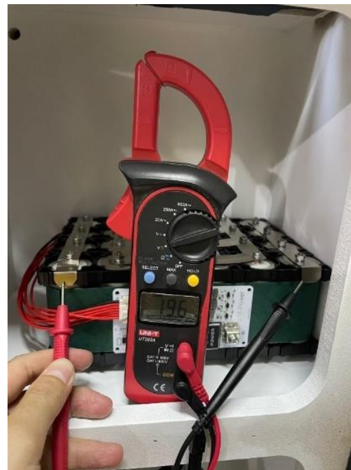
รูปที่ 6 ทดสอบการวัดแรงดันไฟฟ้าจากแบตเตอรี่ลำโพงไอโอที
