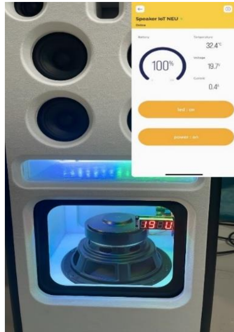
รูปที่ 9 การทดสอบระบบเปิดหรือปิดชุดหลอดไฟระดับ (หลอดแอลอีดี) ผ่านแอปพลิเคชัน
