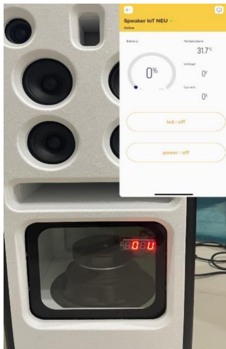
รูปที่ 8 ทดสอบระบบเปิดหรือปิดลำโพงไอโอทีไร้สายผ่านแอปพลิเคชัน
