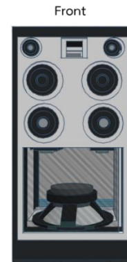
รูปที่ 3 การออกแบบโครงสร้างลำโพงไอโอทีไร้สาย ประมวลผลด้วยไมโครคอนโทรลเลอร์ด้านหน้า
