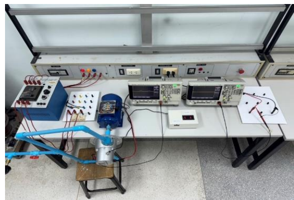
รูปที่ 4 การทดสอบขณะมีภาระไฟฟ้า 9 โอห์ม (36 วัตต์)
