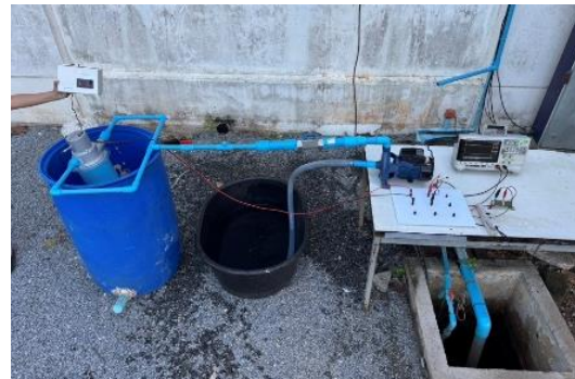
รูปที่ 8 การทดสอบภาระไฟฟ้าด้วยตัวต้านทานแบบปรับค่าได้
