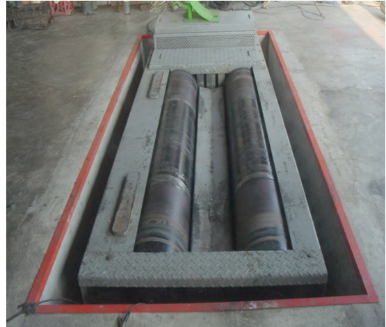
รูปที่ 2. อุปกรณ์โรเตอร์ของเครื่องไดนาโมมิเตอร์
