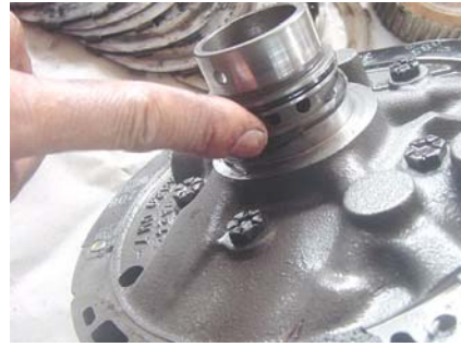
รูปที่6. การตรวจสอบโอริงของเกียร์อัตโนมัติ
