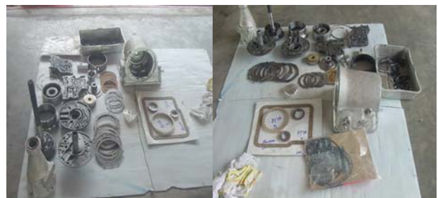
รูปที่9.แสดงการเตรียมอุปกรณ์ทำการล้างเพื่อจะประกอบเกียร์
