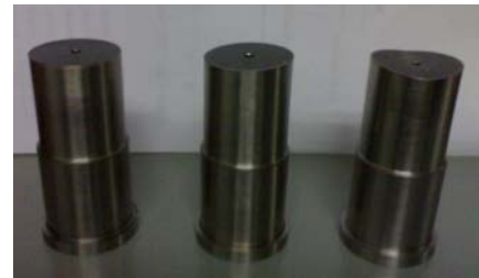
รูปที่ 1 ชุด Punch ทั้ง 3 แบบที่นำมาออกแบบและศึกษา คมตัดตรง (ซ้าย) คมตัดเฉียง (กลาง) และคมตัดหวับาท (ขวา)
