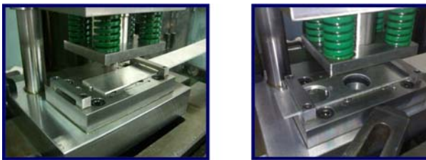
รูปที่ 4 การทดลองตัดอะลูมิเนียมแผ่นบนแม่พิมพ์ตัด
