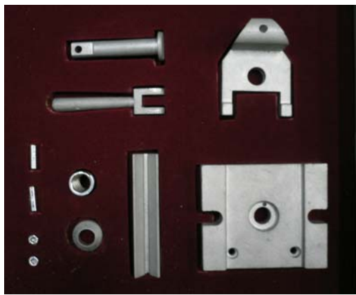
รูปที่ 2. ถอดแยกชิ้นเครื่องมือจับยึดชิ้นงานทรงกระบอก
