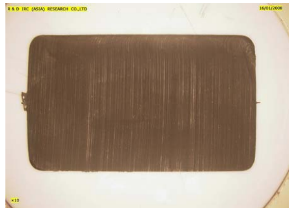
รูปที่ 9 ขึ้นงานตัวอย่างที่สุกตัวทั่วทั้งขึ้นงาน
