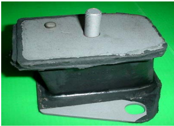
รูปที่ 1 ยางแทนเครื่องรถยนต์ที่ใช้ยึดระหว่างเครื่องยนต์กับตัวถังรถยนต์
