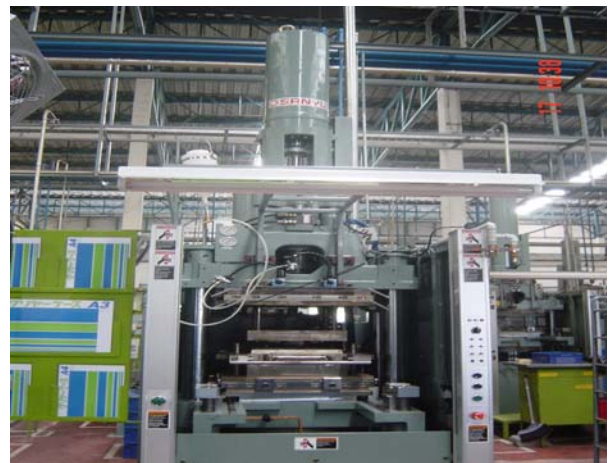
รูปที่ 2 เครื่องฉีดยางแนวตั้งขนาด 150 ตันและมีปริมาตรกระบอกฉีด 1,600 ลูกบาศก์เซนติเมตร
