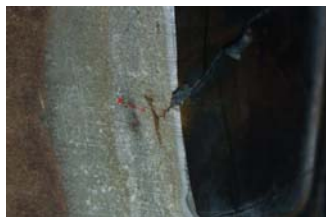
รูปที่ 6 ลักษณะการแตกร้าวของอิพ็อกซีชั้นที่ 1 ถึง 3
