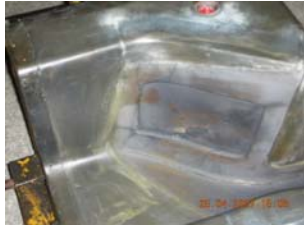
รูปที่ 5 ตัวอย่างการแตกร้าวของของแม่พิมพ์ที่พอกขึ้นในส่วนต่าง ๆ
