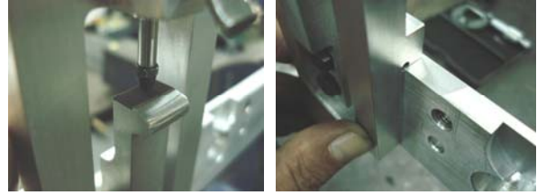
รูปที่ 11. ตำแหน่งก้านวัด (รูปซ้าย) และด้านที่ประกอบเป็นมุมฉากสำหรับเกาะเข้ากับบ่าสวิง (รูปขวา)
