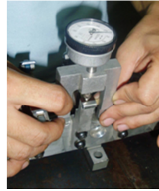
รูปที่2. แสดงต้นแบบเครื่องมือวัดความสูงฐานรองพื้นจับ (gripper pad)
