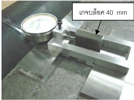
รูปที่ 14. ตำแหน่งการวางแท่งเกจบล็อก (gauge block)
