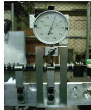
รูปที่ 12. เครื่องมือวัดฐานรองพื้นจับติดนาฬิกาเปรียบเทียบศูนย์
