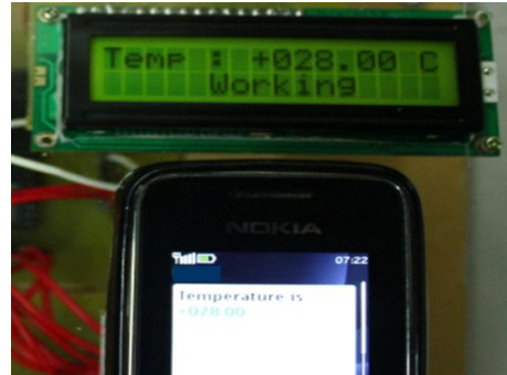
รูปที่ 14 หน้าจอโทรศัพท์มือถือแสดงค่าอุณหภูมิจากการส่งข้อความเปรียบเทียบกับหน้าจอแอลซีดี
