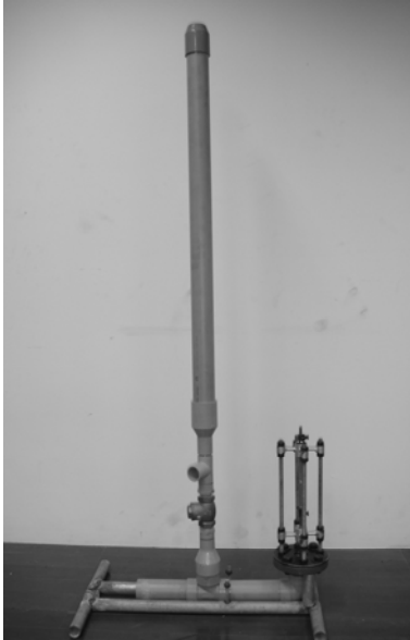
รูปที่ 5 ชุดเครื่องตะบันน้ำที่ประกอบเสร็จแล้ว
