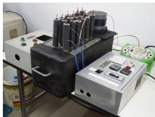
รูปที่ 4 ชุดทดสอบอุปกรณ์ระบายความร้อนน้ำมันไฮดรอลิกส์
