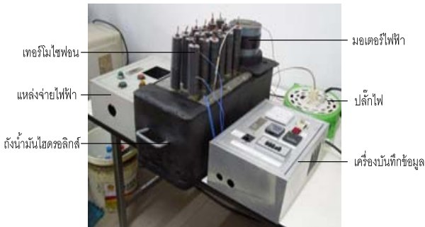
รูปที่ 2 แสดงชุดอุปกรณ์แลกเปลี่ยนความร้อน
