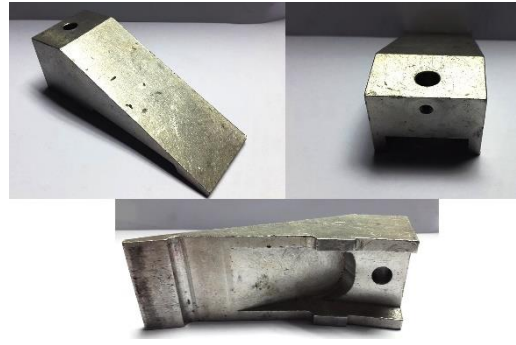
รูปที่ 9 เครื่องมือวัดสร้างโดยใช้วัสดุ อะลูมิเนียมอัลลอย เกรด 6016
