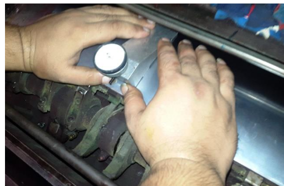
รูปที่ 10 ตัวเรือนของเครื่องมือเมื่อครอบบนฐานรองพื้นจับไม่สามารถมองเห็นทำให้ปลายของก้านวัดเลื่อนหลุดจากฐานรองพื้นจับ
