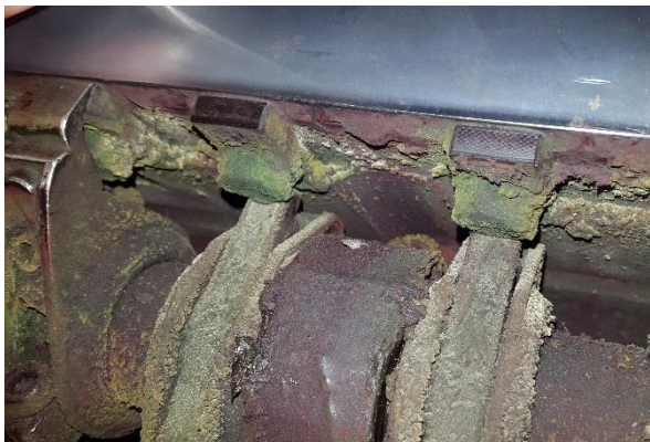
รูปที่ 2 ฐานรองฟันจับ (Gripper Pad) ที่ใช้งานมานานจนสึกและเอียง
