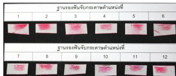
รูปที่ 21 ผลการทดลองวัดปรับตั้งความตรงของฐานรองพื้นจับกระดาษ จำนวน 12 ตัว ของไมกอดพิมพ์ด้วยกระดาษเคมี
