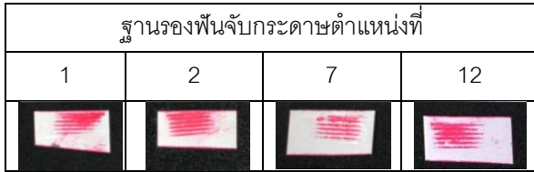
รูปที่ 22 ฐานรองพินจับกระดาศจำนวน 4 ตัว ของโมกดพิมพ์ ที่ไม่ตรง
