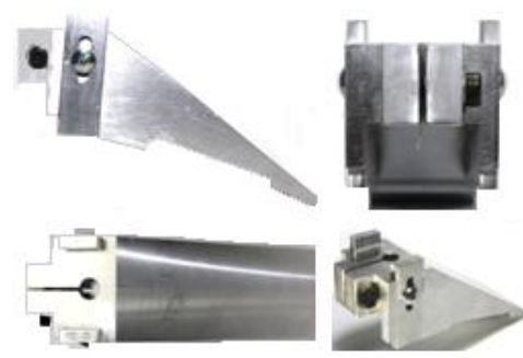
รูปที่ 13 เครื่องมือวัดปรับตั้งฐานรองฟันจับกระดาด ปรับปรุง ครั้งที่ 1 ก่อนนำไปทดลอง
