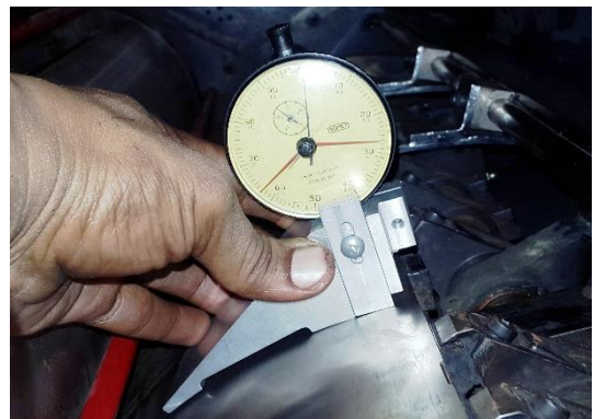
รูปที่ 14 เครื่องมือวัดที่สร้างเสร็จแล้วนำมาทดลองทาบกับผิว ของโมกดพิมพ์เพื่อวัดความสูงของฐานรองฟันจับ
