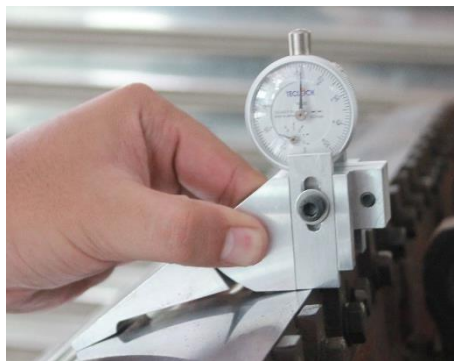
รูปที่ 20 เครื่องมือวัดปรับตั้งฐานรองพื้นจับกระดาษทดลองวัดปรับตั้งความสูงฐานรองพื้นจับของไมกอดพิมพ์
