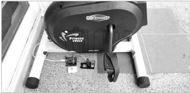
รูปที่ 12 การติดตั้งและทดสอบการคำนวณวัดระยะห่างระหว่างเซ็นเซอร์กับบันไดจักรยาน เพื่อส่งข้อมูลไปยัง Firebase Real-Time Database
