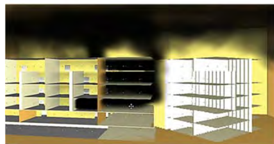
รูปที่ 11 แสดงจุดกำเนิดไฟไหม้ของสถานการณ์ที่ 4 (บน) และลักษณะการแพร่กระจายของควัน (ล่าง)
