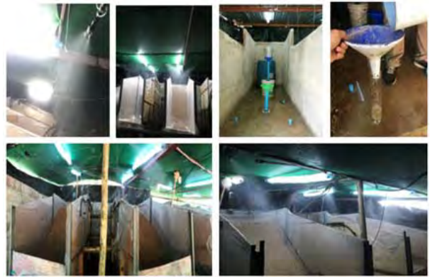
รูปที่ 4 การทดสอบจำลองปริมาณน้ำฝนแนวคดจากการ ทดสอบได้จากงานวิจัยที่ผ่านมาปริมาณน้ำฝนไม่น้อยกว่า 150 มิลลิเมตร/วัน
