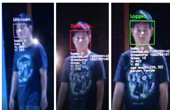
รูปที่ 9 การทดสอบการตรวจจับภาพใบหน้าคนใน ห้องปฏิบัติการจากโมดูลกล้องที่ถูกเชื่อมต่อกับบอร์ดประมวลผลความเร็วสูง NVIDIA Jetson Nano
