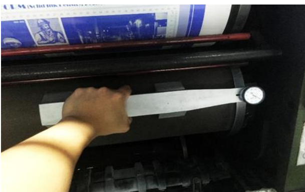
รูปที่ 14 แสดงการวัดระยะลึกป่าโมแม่พิมพ์ด้วยเครื่องมือวัดร่อนหุนมาตรฐาน
