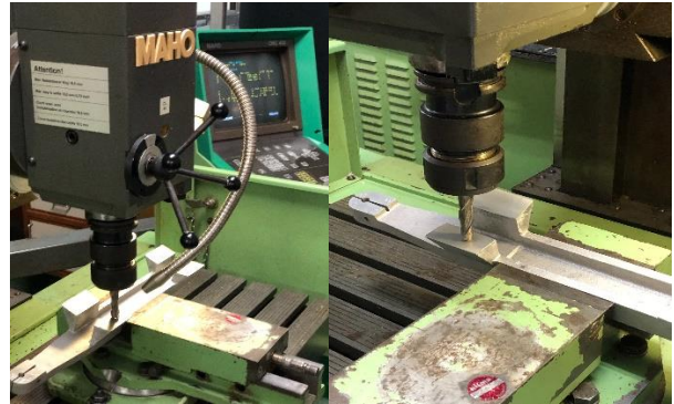
รูปที่ 12 การใช้เครื่องจักร CNC กัดชิ้นงานให้ได้ระดับ
