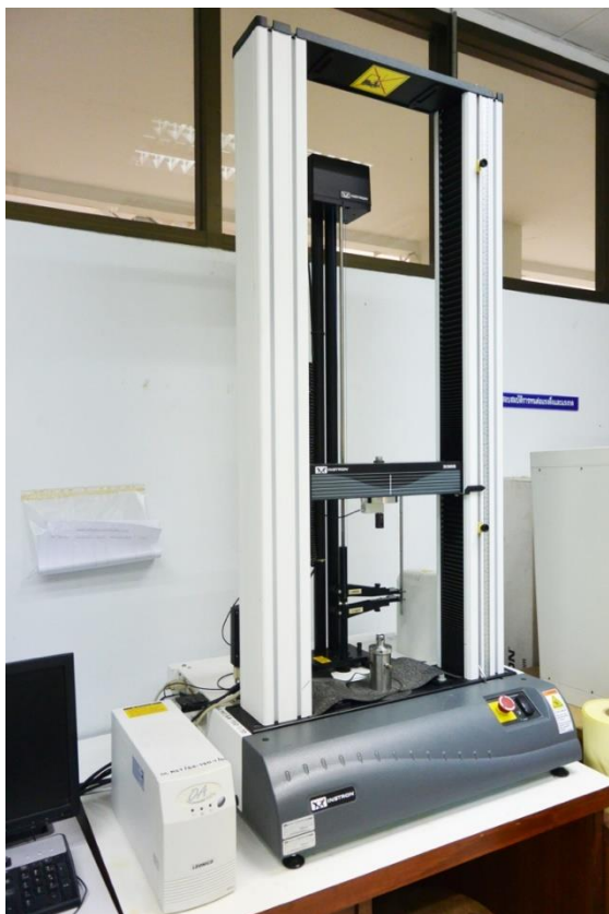
รูปที่ 4 เครื่องทดสอบความต้านทานต่อแรงดึง 3365 Instron tensile testing machine
