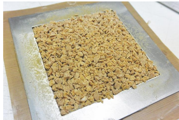
รูปที่ 2 เม็ดผสม PLA/Sisal ในแม่พิมพ์เพื่อเตรียมอัดขึ้นรูป
