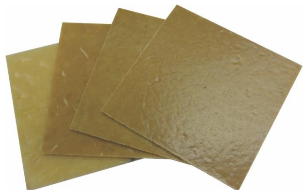
รูปที่ 3 PLA/Sisal อัดขึ้นรูปแบบแผ่น ที่อัตราส่วน 10, 20, 30 และ 40 wt% ตามลำดับ
