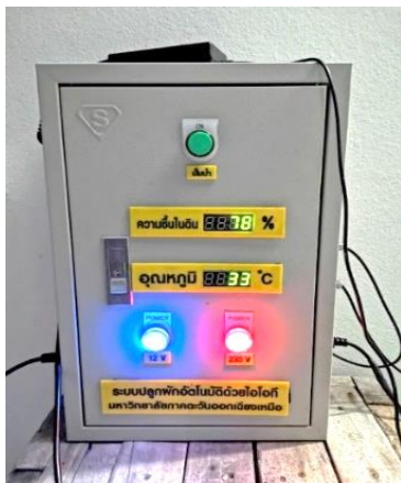
รูปที่ 7 การทำงานของจอแสดงผลอุณหภูมิและความขึ้น
