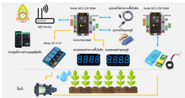
รูปที่ 5 อุปกรณ์และความสัมพันธ์ของระบบปลูกผักแบบอัตโนมัติ
