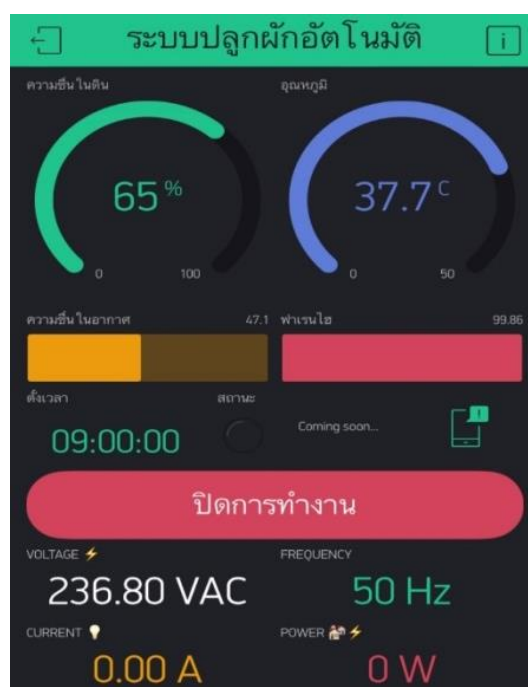
รูปที่ 8 หน้าจอแอปพลิเคชันที่ใช้ในการเปิด-ปิดการทำงานของปั๊มน้ำ
