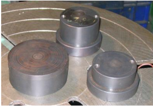
รูปที่ 12 งานชุบแข็งแม่พิมพ์กลาง บนและล่าง
