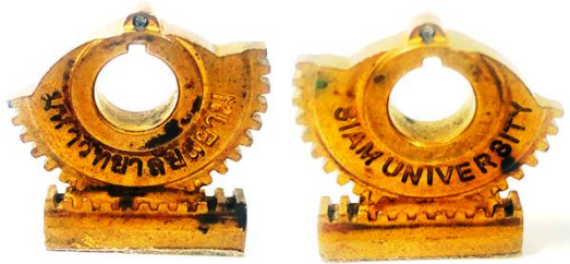
รูปที่ 16 ชิ้นงานปั๊มขึ้นรูปจากโลหะผงด้วยเครื่องปั๊มโลหะผง ขนาดกำลังอัดสูงสุด 40 ตัน
