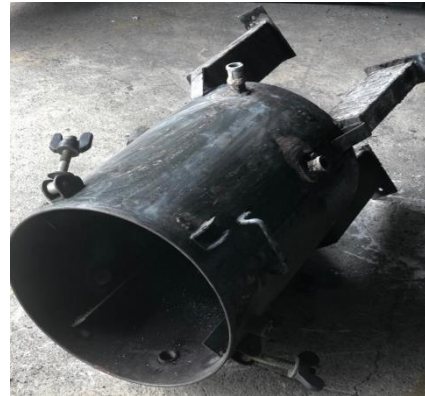
รูปที่ 5 เชื่อมถังพักน้ำและถังกรองน้ำขนาด 50 ลิตร
