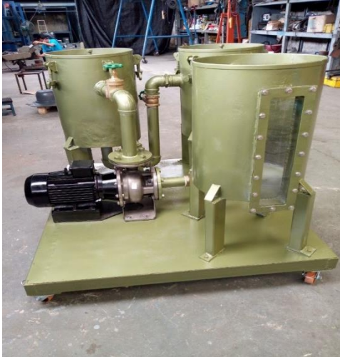
รูปที่ 8 ติดตั้งมอเตอร์ปั้มน้ำแบบหอยโข่ง ขนาด 5.5 แรงม้า ที่ความเร็วรอบ 2,900 รอบต่อนาที
