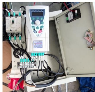
รูปที่ 7 ปรับรอบการหมุนของมอเตอร์ด้วย อินเวอร์เตอร์ ขนาด 2 แรงม้า 220 โวลต์ 1 เฟส
