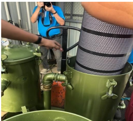
รูปที่ 9 ไส้กรองหยาบกรองอนุภาคขนาด 20 ไมครอน และละเอียดกรองอนุภาคขนาด 5 ไมครอน
