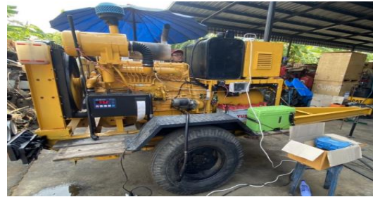
รูปที่ 6 เครื่องยนต์ดีเซล HINO รุ่น EH100 ขนาดความจุ 5,871 CC. กำลังการผลิตไฟฟ้า 60 กิโลวัตต์
