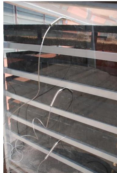
รูปที่ 2 ตำแหน่งวัดอุณหภูมิ (h) ด้วย Thermocouple จากระดับพื้นตู้อบ ( h=39.5, 69.5 และ 99.5 cm)
