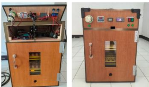
รูปที่ 4 โครงสร้างตู้พักไข่ในครัวเรือนที่ถ่ายจากภาพจริง
