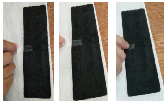
รูปที่ 2 ผลทดสอบการยึดติดโดยใช้เทปใส (Transparent Tape Number 600)
